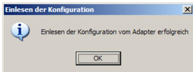
signalisiert das erfolgreiche Auslesen der Konfigurationsdaten aus dem Adapter. Die Konfiguration wird dargestellt und ausgeführt. (Wenn kein Empfangsstring vorhanden ist, kann die Ausgabe nicht korrekt aufbereitet werden und es werden eventuell nur Zeichen dargestellt, die eingefügt, oder angehängt werden sollen.)
