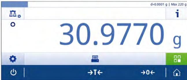
⇒ Nach kurzer Zeit stabilisiert sich die Waagschale. Der Instabilitätssymbol
