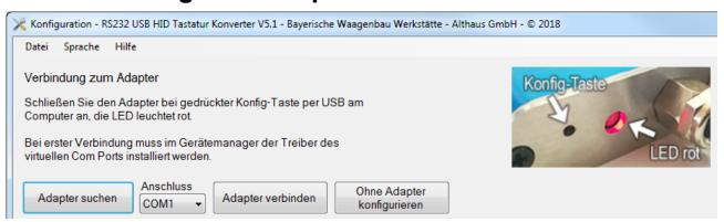
Nach dem Start der Konfigurationssoftware können Sie wählen ob eine Verbindung hergestellt werden soll oder ob Sie die Software ohne Adapter verwenden möchten.
