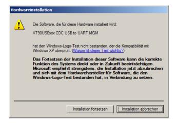
Mit ,Installation fortsetzen', wird der Treiber installiert. Danach ist der Virtuelle Serielle ComPort verfügbar, in diesem Beispiel COM6. Die COM Nummer variiert bei der Installation.
